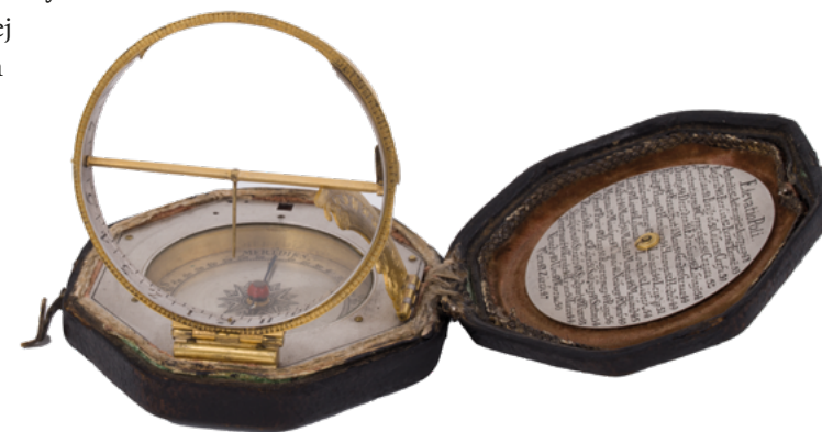
Przenośny zegar słoneczny typu augsburskiego wykonany na początku XVIII w. Niewielki rozmiar oraz obecność kwadrantu, czyli urządzenia do wyznaczania położenia gwiazd, wskazują, że zegar ten był ważnym towarzyszem dalekich podróży.
